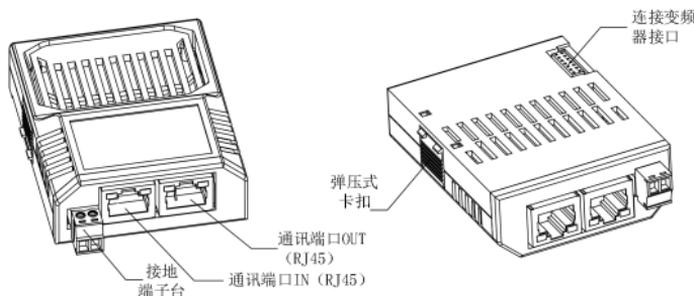
其端子主要有接地端子、两个 RJ45 接口，以及连接变频器的端口。
