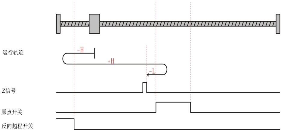
电机当前位置位于原点开关有效处，回零启动时原点开关高电平，反向低速运行遇到Z信号上升沿停机。
