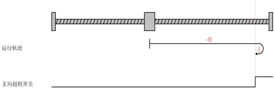
电机当前位置位于正向超程开关有效处，回零启动时正向超程开关高电平，反向低速运行，遇到正向超程开关下降沿停机。
