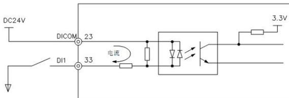
图 4-3 DI 端子干接点连接方式
