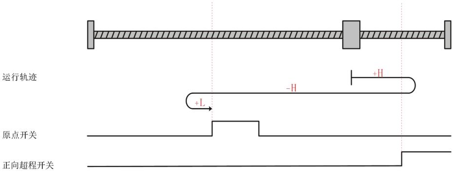
电机当前位置在零点开关有效处，回零启动时原点开关高电平，反向高速回零，遇到原点开关下降沿后，正向低速运行，遇到原点开关上升沿停机。
