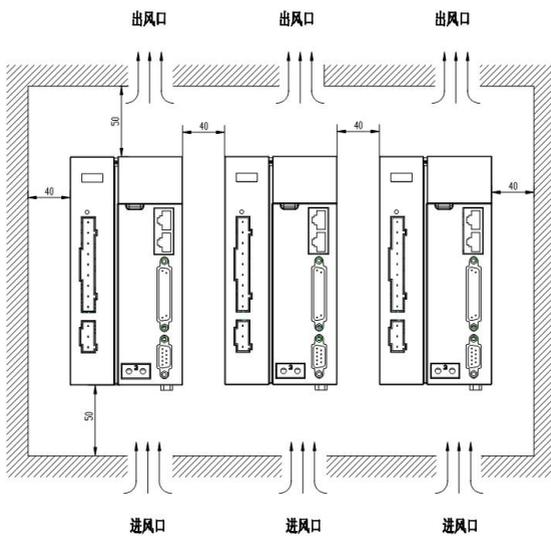
图 3-2 SIZE B/C 伺服安装示意图
