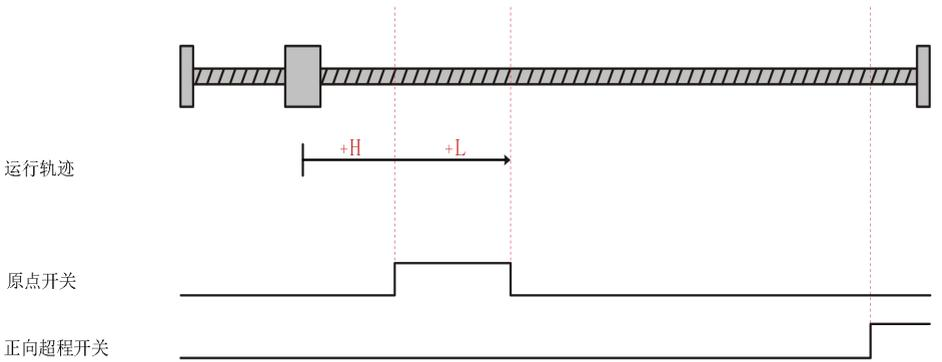
电机当前位置位于正向超程开关和原点开关之间，回零启动时原点开关低电平，正向高速运行，遇到正向超程开关上升沿后，反向高速运行，遇到原点开关上升沿，正向低速运行，遇到原点开关下降沿停机。
