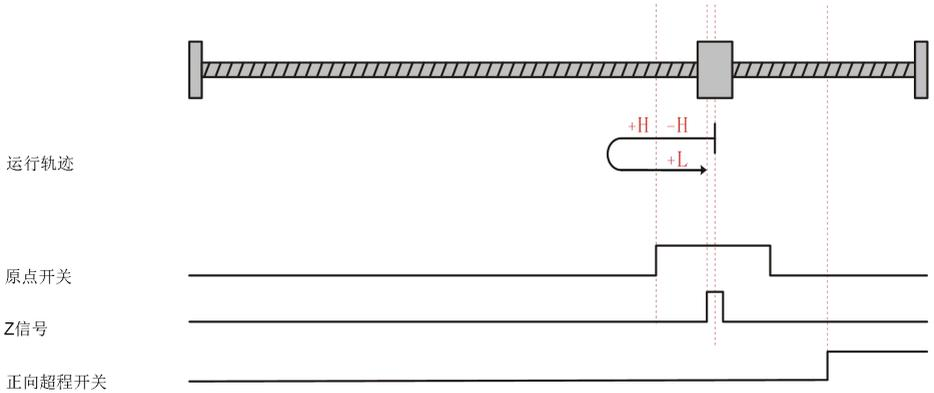
电机当前位置在原点开关和正向超程开关中间，回零启动时原点开关低电平，正向高速回零，遇到正向超程开关上升沿后，反向高速运行，遇到原点开关下降沿后，再正向高速运行，遇到原点开关上升沿正向低速找Z信号上升沿停机。
