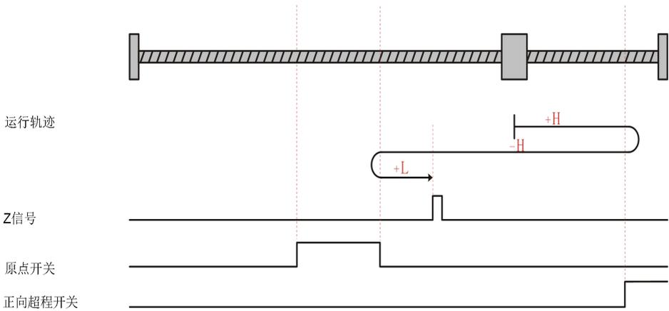
电机当前位置位于原点开关有效处，回零启动时原点开关高电平，正向低速回零，遇到Z信号上升沿停机。
