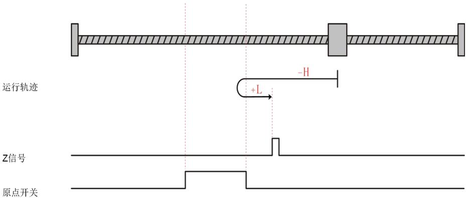
电机当前位置位于原点开关有效处，回零启动时原点开关高电平，正向低速回零，遇到原点开关下降沿后，正向低速运行，遇到Z信号上升沿停机。
