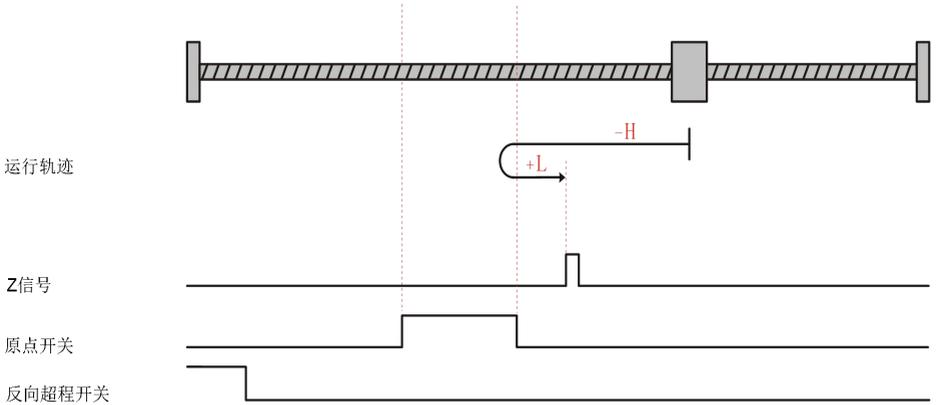
电机当前位置位于反向超程开关和原点开关之间，回零启动时原点开关低电平，反向高速回零，遇到反向超程开关上升沿后，正向高速运行，遇到原点开关上升沿后，再正向低速运行，遇到Z信号上升沿停机。
