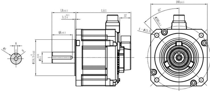
图 2-8 180 框号中惯量伺服电机外形尺寸图
