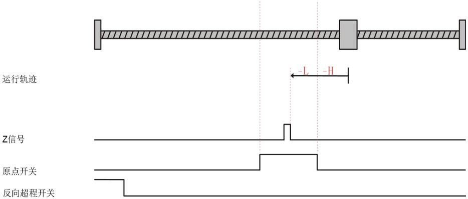
电机当前位置位于反向超程开关和原点开关之间，回零启动时原点开关低电平，反向高速回零，遇到反向超程开关上升沿后，正向高速运行，遇到原点开关下降沿后，反向高速运行，遇到原点开关上升沿后，再反向低速运行，遇到Z信号上升沿停机。
