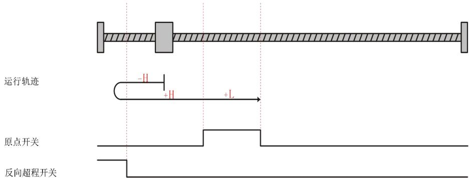
电机当前位置位于原点开关有效处，回零启动时原点开关高电平，正向低速运行，遇到原点开关下降沿停机。
