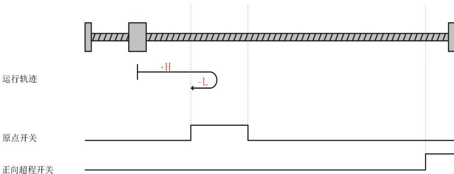
电机当前位置位于正向超程开关和原点开关之间，回零启动时原点开关低电平，正向高速运行，遇到正向超程开关上升沿后，反向高速运行，遇到原点开关上升沿后，反向低速运行，遇到原点开关下降沿停机。
