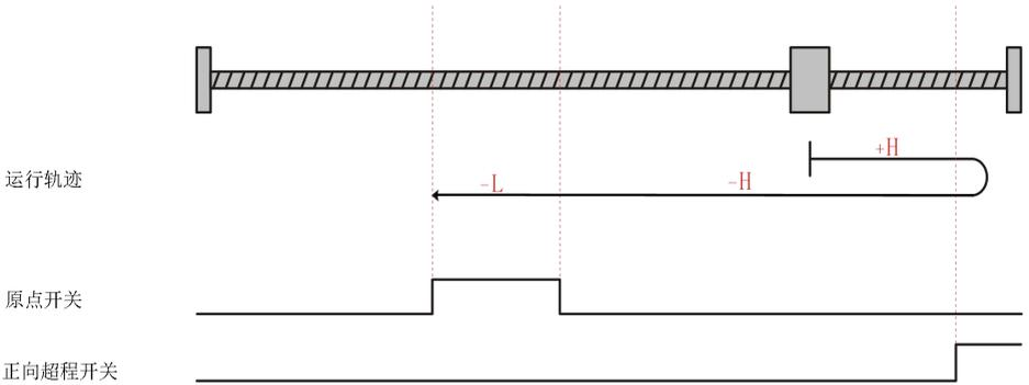
电机当前位置位于原点开关有效处，回零启动时原点开关高电平，反向低速运行，遇到原点开关下降沿停机。
