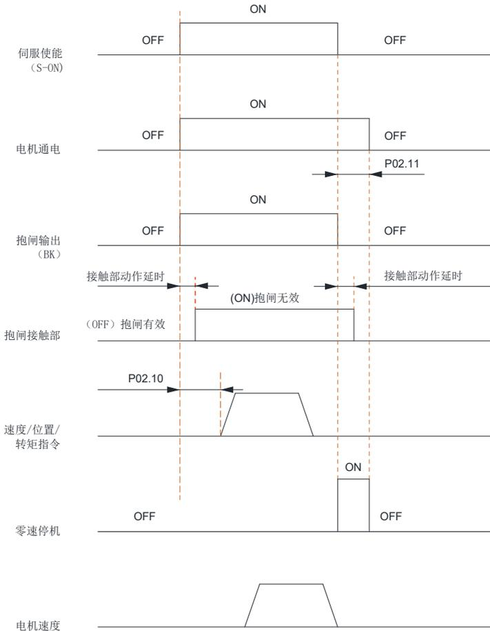
图 6-4 电机静止时抱闸时序图
