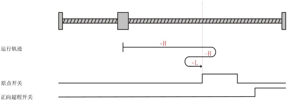
电机当前位置在零点开关和正向超程开关中间，回零启动时原点开关低电平，正向高速回零，遇到正向超程开关后，反向高速运行，遇到原点开关下降沿后，再正向低速运行，遇到原点开关上升沿停机。
