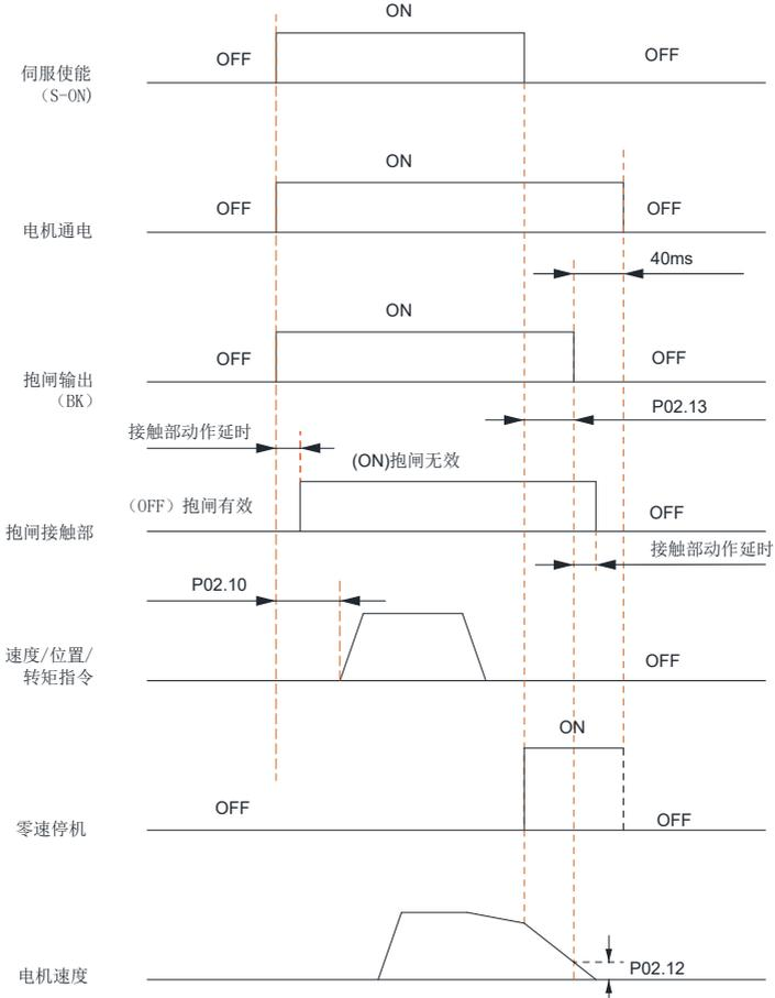
图 6-5 电机旋转时抱闸时序图
