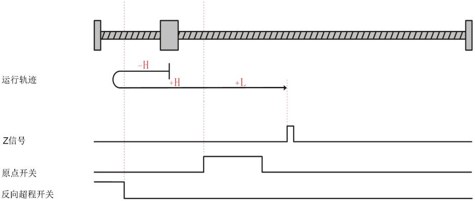
电机当前位置位于原点开关有效处，回零启动时原点开关高电平，正向低速运行，遇到Z信号上升沿停机。
