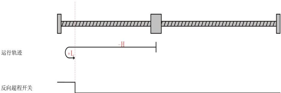
电机当前位置位于反向超程开关有效处，回零启动时反向超程开关高电平，正向低速运行，遇到反向超程开关下降沿停机。
