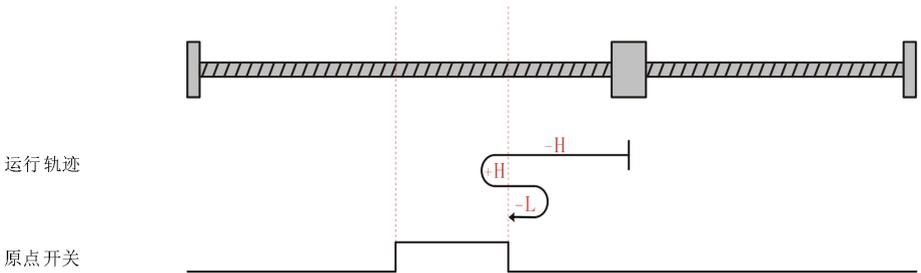
电机当前位置在原点开关有效处，回零启动时原点开关高电平，正向高速回零，遇到原点开关下降沿后，反向低速运行，遇到原点开关上升沿停机。
