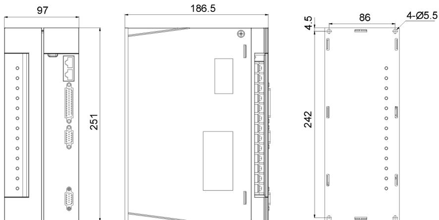
图 2-3 SIZE C 伺服驱动器外形尺寸图
