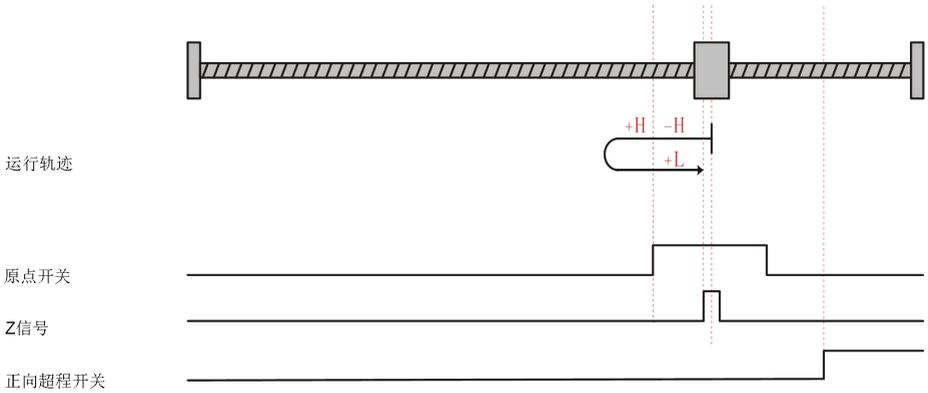
电机当前位置在零点开关和正向超程开关中间，回零启动时原点开关低电平，正向高速回零，遇到正向超程开关上升沿后，反向高速运行，遇到原点开关下降沿后，再正向高速运行，遇到原点开关上升沿正向低速找Z信号上升沿停机。
