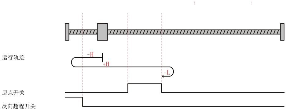
电机当前位置在原点开关有效处，回零启动时原点开关高电平，正向高速回零，遇到原点开关下降沿后，反向低速运行，遇到原点开关上升沿停机。
