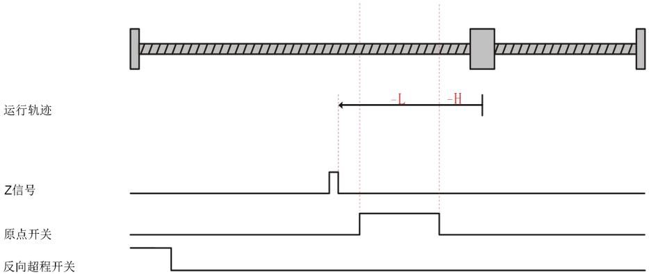
电机当前位置位于反向超程开关和原点开关之间，回零启动时原点开关低电平，反向高速回零，遇到反向超程开关上升沿后，正向高速运行，遇到原点开关上升沿后，反向低速运行，遇到Z信号上升沿停机。
