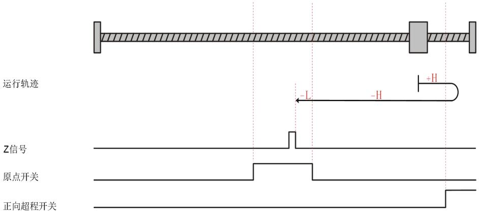
电机当前位置位于原点开关有效处，回零启动时原点开关高电平，正向高速回零，遇到原点开关下降沿后，反向高速运行，遇到原点开关上升沿后，再反向低速运行，遇到Z信号上升沿停机。
