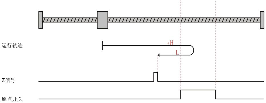
电机当前位置位于原点开关有效处，回零启动时原点开关高电平，反向低速回零，遇到原点开关下降沿后，反向低速运行，遇到Z信号上升沿停机。
