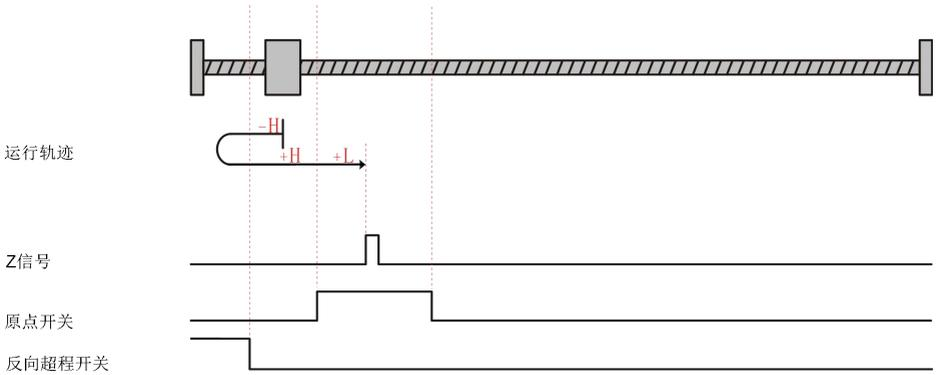
电机当前位置位于原点开关有效处，回零启动时原点开关高电平，反向高速回零，遇到原点开关下降沿后，正向高速运行，遇到原点开关上升沿后，正向低速运行遇到Z信号上升沿停机。
