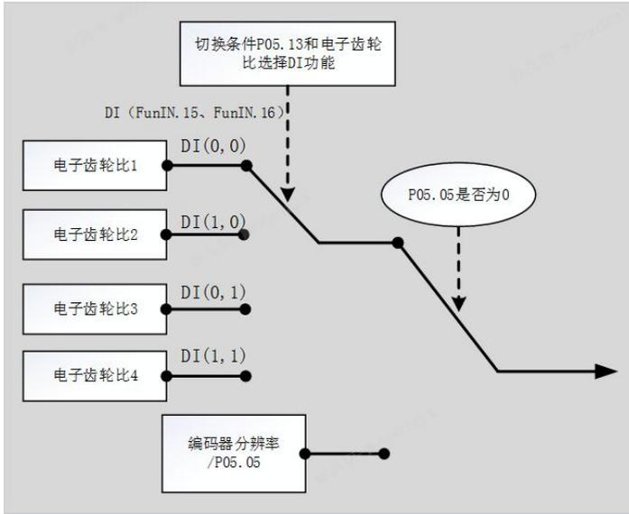
图 6-2 电子齿轮比功能示意图
