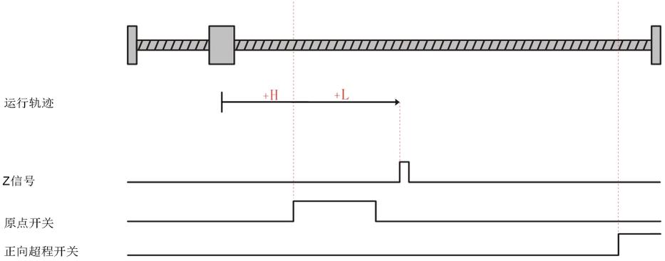
电机当前位置位于正向超程开关和原点开关之间，回零启动时原点开关低电平，正向高速回零，遇到正向超程开关上升沿，反向高速运行，遇到原点开关上升沿后，正向低速运行，遇到Z信号上升沿停机。
