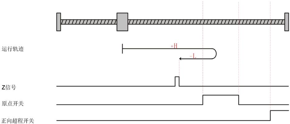
电机当前位置位于原点开关有效处，回零启动时原点开关高电平，反向低速回零，遇到原点开关下降沿后，反向低速运行，遇到Z信号上升沿停机。
