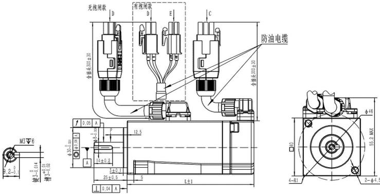
图 2-4 40 框号中惯量伺服电机外形尺寸图
