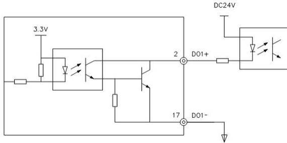
图 4-7 DO 端子漏型 (NPN) 输出接线方式
