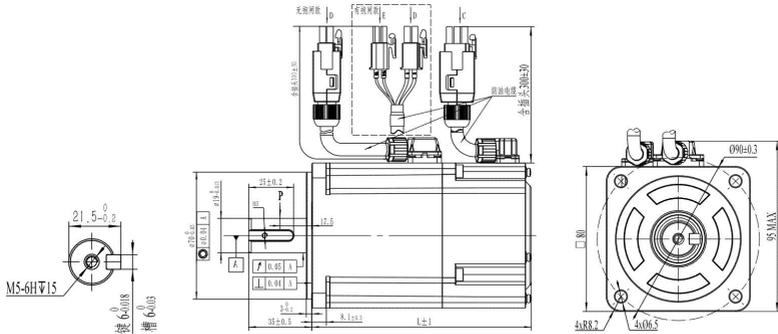
图 2-6 80 框号中惯量伺服电机外形尺寸图
