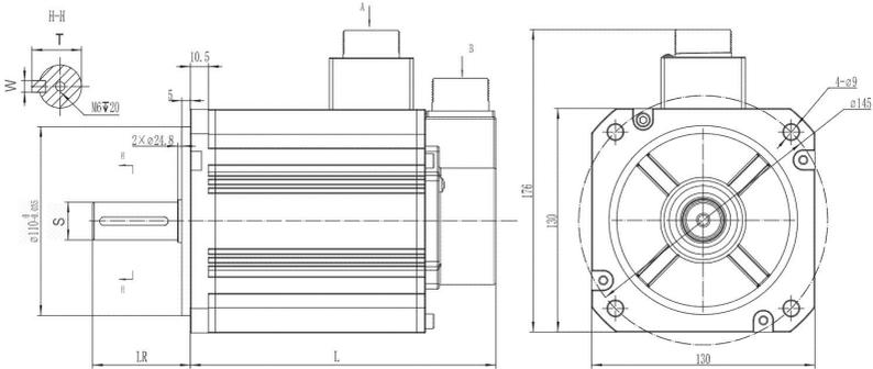
图 2-7 130 框号中惯量伺服电机外形尺寸图
