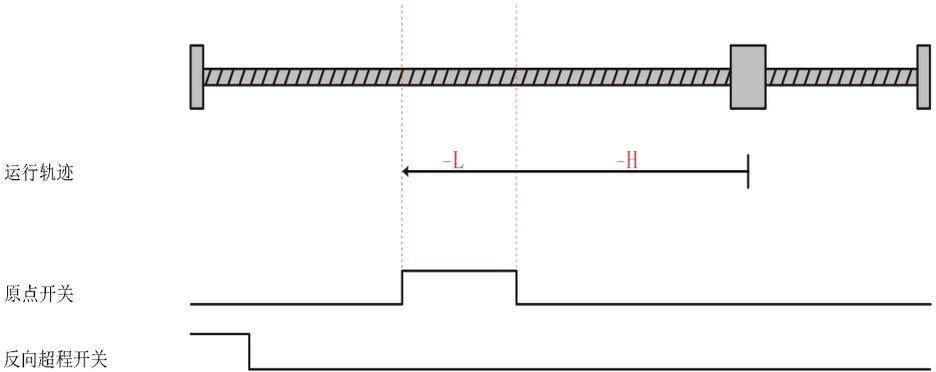
电机当前位置位于反向超程开关和原点开关之间，回零启动时原点开关低电平，反向高速运行，遇到反向超程开关上升沿，正向高速运行，遇到原点开关上升沿，反向低速运行，遇到原点开关下降沿停机。
