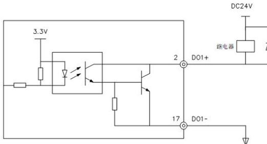
图 4-6 DO 端子连接继电器接线方式
