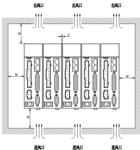
图 3-1 SIZE A 伺服安装示意图
