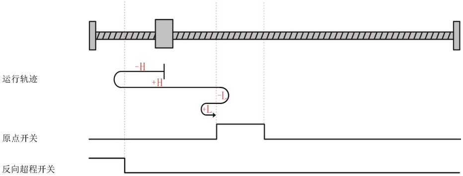
电机当前位置位于原点开关有效处，回零启动时原点开关高电平，反向低速运行，遇到原点开关下降沿，再正向低速运行，遇到原点开关上升沿停机。
