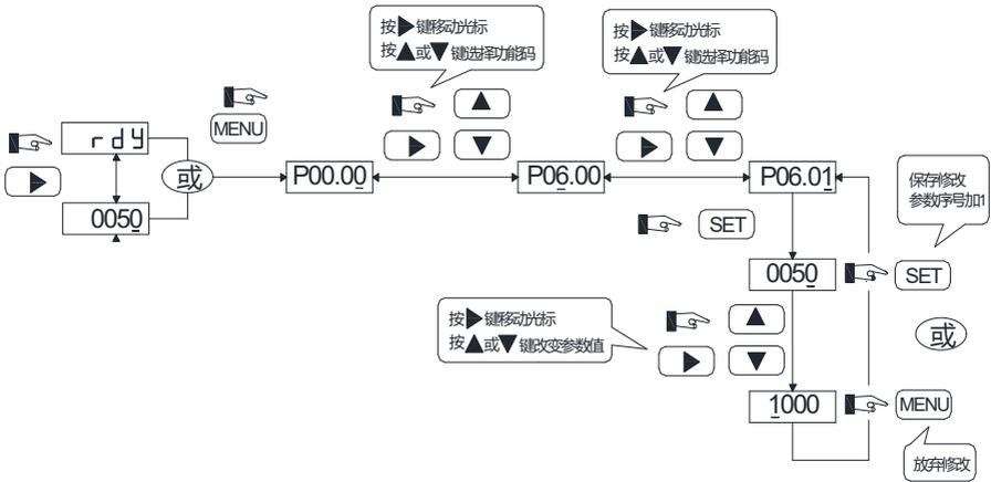
图 5-2 工作状态显示及参数设定流程图
