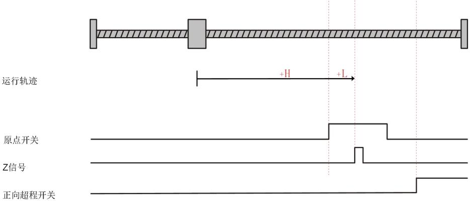
电机当前位置在原点开关有效处，回零启动时原点开关高电平，反向高速回零，遇到原点开关下降沿后，正向高速运行，遇到原点开关上升沿后，再正向低速找Z信号上升沿停机。
