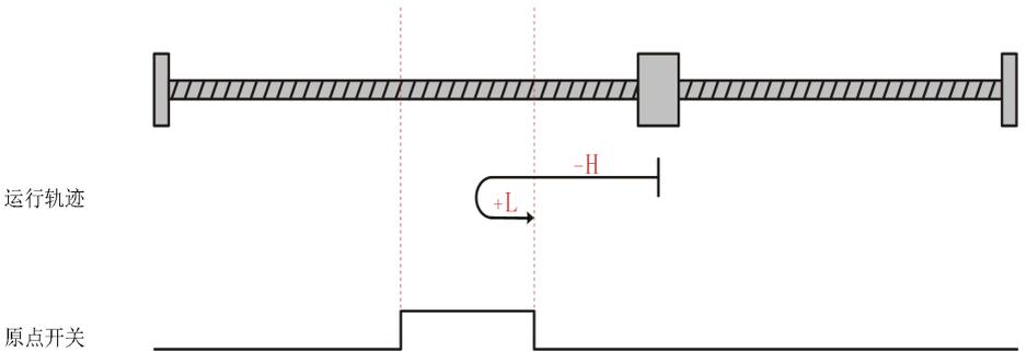
电机当前位置位于原点开关有效处，回零启动时原点开关高电平，正向低速运行，遇到原点开关下降沿停机。
