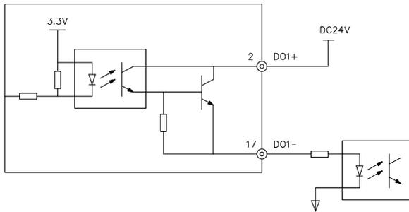
图 4-8 DO 端子源型 (PNP) 输出接线方式
