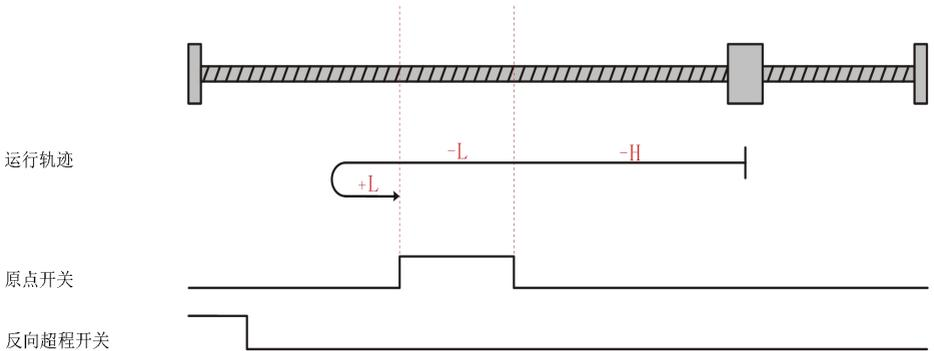
电机当前位置位于反向超程开关和原点开关之间，回零启动时原点开关低电平，反向高速运行，遇到反向超程开关上升沿，正向高速运行，遇到原点开关上升沿，反向低速运行，遇到原点开关下降沿，正向低速运行，遇到原点开关上升沿停机。
