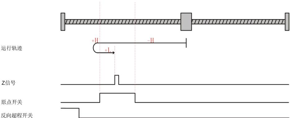
电机当前位置位于反向超程开关和原点开关之间，回零启动时原点开关低电平，反向高速回零，遇到反向超程开关上升沿后，正向高速运行，遇到原点开关上升沿后，正向低速运行遇到Z信号上升沿停机。
