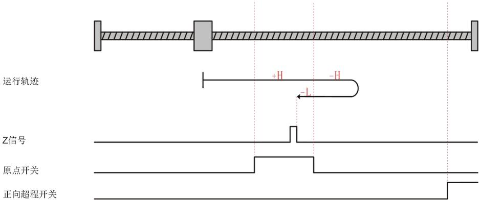
电机当前位置位于正向超程开关和原点开关之间，回零启动时原点开关低电平，正向高速回零，遇到正向超程开关上升沿后，反向高速运行，遇到原点开关上升沿后，再反向低速运行，遇到Z信号上升沿停机。
