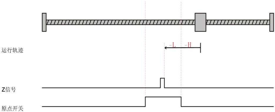
电机当前位置位于原点开关有效处，回零启动时原点开关高电平，正向高速回零，遇到原点开关下降沿后，反向高速运行，遇到原点开关上升沿后，反向低速运行遇到Z信号上升沿停机。
