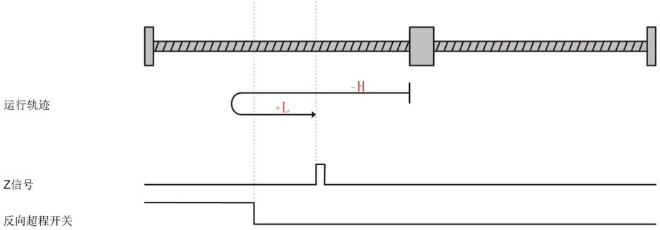
电机当前位置在反向超程开关处，回零启动时反向超程开关高电平，正向低速回零，遇到反向超程开关下降沿后，正向低速运行，遇到Z信号上升沿停机。
