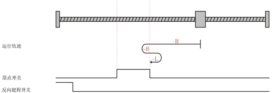
电机当前位置在反向超程开关和原点开关中间，回零启动时原点开关低电平，反向高速回零，遇到反向超程开关后，正向高速运行，遇到原点开关下降沿后，再反向低速运行，遇到原点开关上升沿停机。
