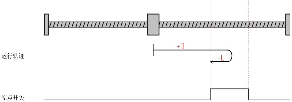
电机当前位置位于原点开关有效处，回零启动时原点开关高电平，反向低速运行，遇到原点开关下降沿停机。
