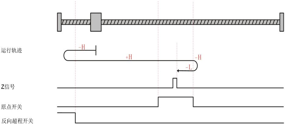
电机当前位置位于原点开关有效处，回零启动时原点开关高电平，正向高速回零，遇到原点开关下降沿后，反向高速运行，遇到原点开关上升沿后，反向低速运行遇到Z信号上升沿停机。
