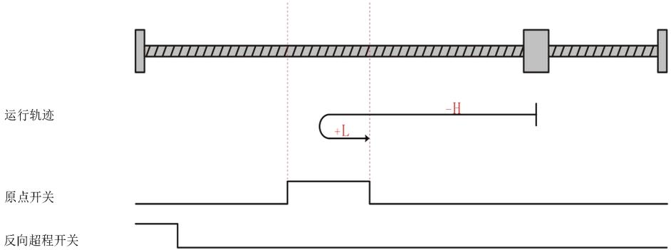
电机当前位置位于反向超程开关和原点开关之间，回零启动时原点开关低电平，反向高速运行，遇到反向超程开关上升沿，正向高速运行，遇到原点开关上升沿，正向低速运行，遇到原点开关下降沿停机。
