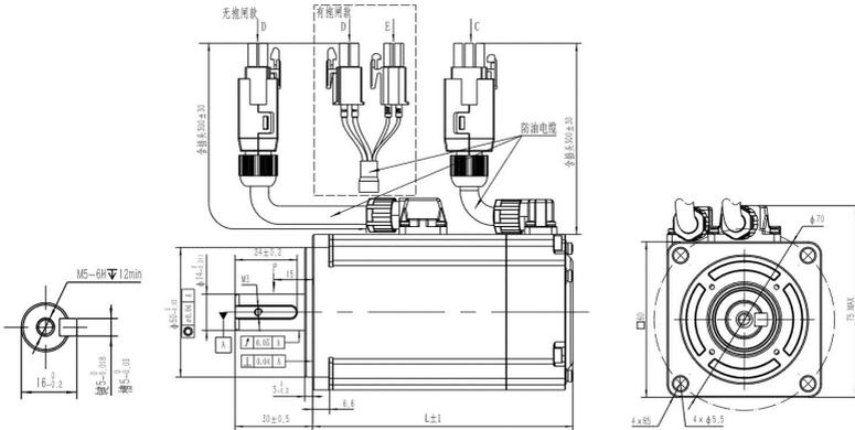
图 2-5 60 框号中惯量伺服电机外形尺寸图
