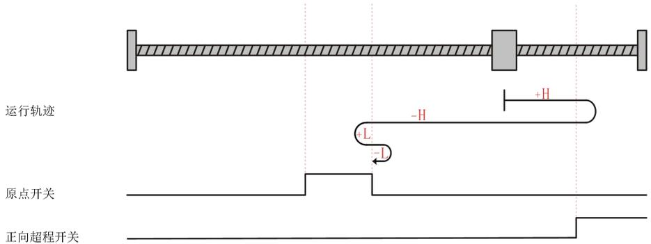
电机当前位置位于原点开关有效处，回零启动时原点开关高电平，正向低速运行，遇到原点开关下降沿，再反向低速运行，遇到原点开关上升沿停机。
