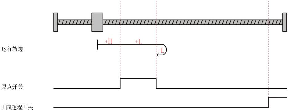
电机当前位置位于正向超程开关和原点开关之间，回零启动时原点开关低电平，正向高速运行，遇到正向超程开关上升沿，反向高速运行，遇到原点开关上升沿，正向低速运行，遇到原点开关下降沿，反向低速运行，遇到原点开关上升沿停机。
