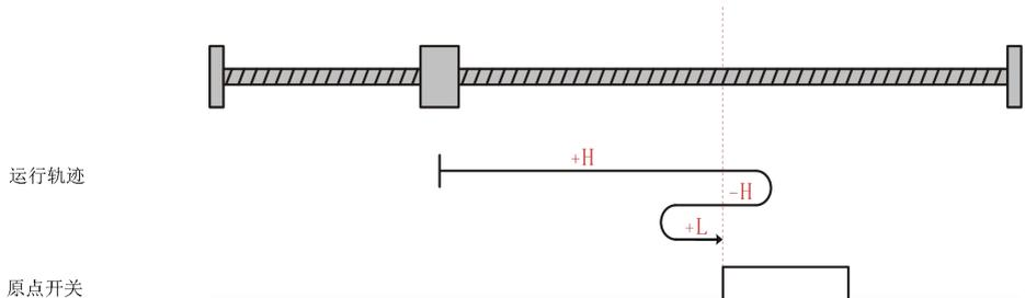
电机当前位置在原点开关有效处，回零启动时原点开关高电平，反向高速回零，遇到原点开关下降沿后，正向低速运行，遇到原点开关上升沿停机。
