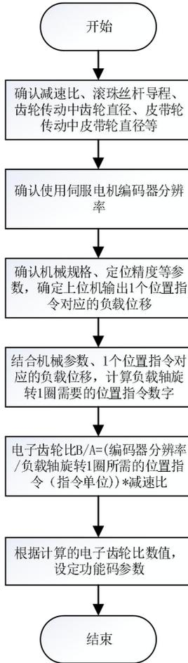
图 6-1 电子齿轮比设置流程
