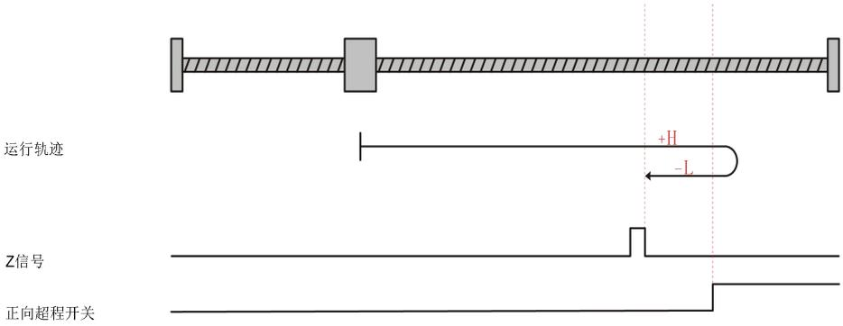
电机当前位置在正向超程开关处，回零启动时正向超程开关高电平，反向低速回零，遇到正向超程开关下降沿后，反向低速运行，遇到Z信号上升沿停机。
