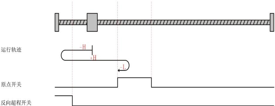
电机当前位置位于原点开关有效处，回零启动时原点开关高电平，反向低速运行，遇到原点开关下降沿停机。
