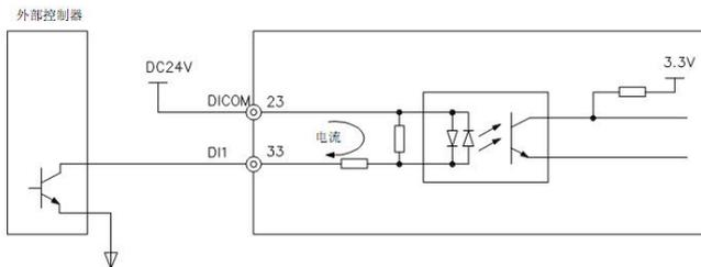
图 4-4 DI 端子 NPN 连接方式
