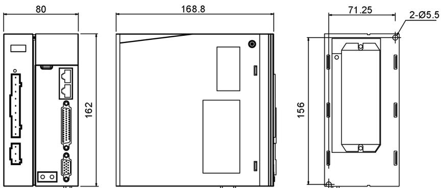
图 2-2 SIZE B 伺服驱动器外形尺寸图
