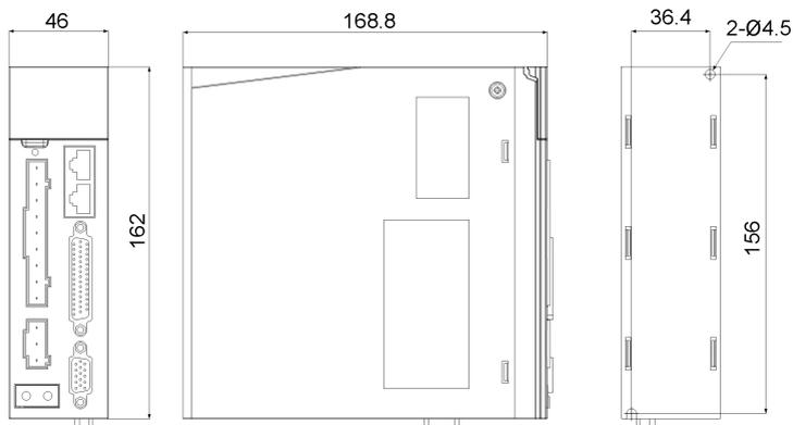
图 2-1 SIZE A 伺服驱动器外形尺寸图
