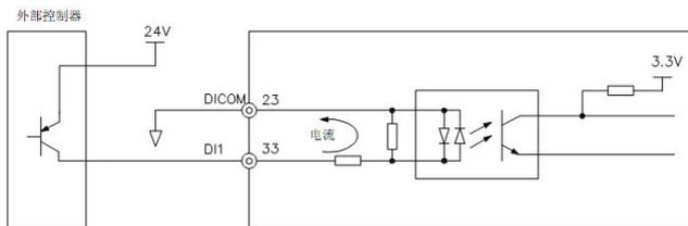
图 4-5 DI 端子 PNP 连接方式
